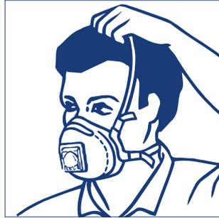
2. Ziehen Sie das untere Band über den Kopf bis in den Nacken und das obere Band bis oberhalb der Ohren. Achten Sie darauf, daß die Bänder nicht verdreht sind.
