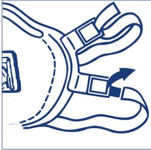
1. Ziehen Sie das obere lose Bandende durch die obere Klemmschnalle und das untere Bandende durch die untere Klemmschnalle (Nasenbügel nach oben).
