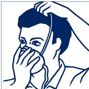
2. Setzen Sie die Maske unter dem Kinn an - den Nasenbügel nach oben.
