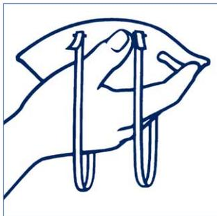
1. Zum Aufsetzen legen Sie die Maske auf die Hand, so daß die Kopfbänder nach unten hängen.
