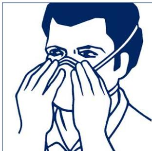
5. Überprüfen Sie den Dichtsitz, indem Sie die Maske mit beiden Händen umschließen und kräftig ausatmen. Bei Luftaustritt am Nasenbügel muß dieser stärker
